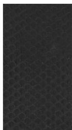
**GOFRADO** Sobre la superficie inferior de la membrana revestida con película Flamina permite una colocación segura y rápida; bajo el efecto de la llama se vuelve lisa y señala la fusión justa a la vez que permite una retracción más rápida de la película. El gofrado permite también una buena difusión del vapor; en la colocación en semi-independencia y en independencia, evita burbujas y protuberancia en los puntos donde queda intacta.
