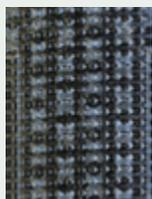
**FILM TERMOFUSIBLE** Sobre la superficie inferior de la membrana revestida con película Flamina permite una colocación segura y rápida; bajo el efecto de la llama se vuelve lisa y señala la fusión justa a la vez que permite una retracción más rápida de la película. El film termofusible permite también una buena difusión del vapor; en la colocación en semi-independencia y en independencia, evita burbujas y protuberancia en los puntos donde queda intacta.
