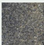
**ARENADA** Se realiza para la adhesión en caliente de arena de minerales que no poseen sílice libre, evita el encolado de las espiras del rollo y actúa como intermediario de adhesión para pinturas y adhesivos aplicados tanto en caliente como en frío.
